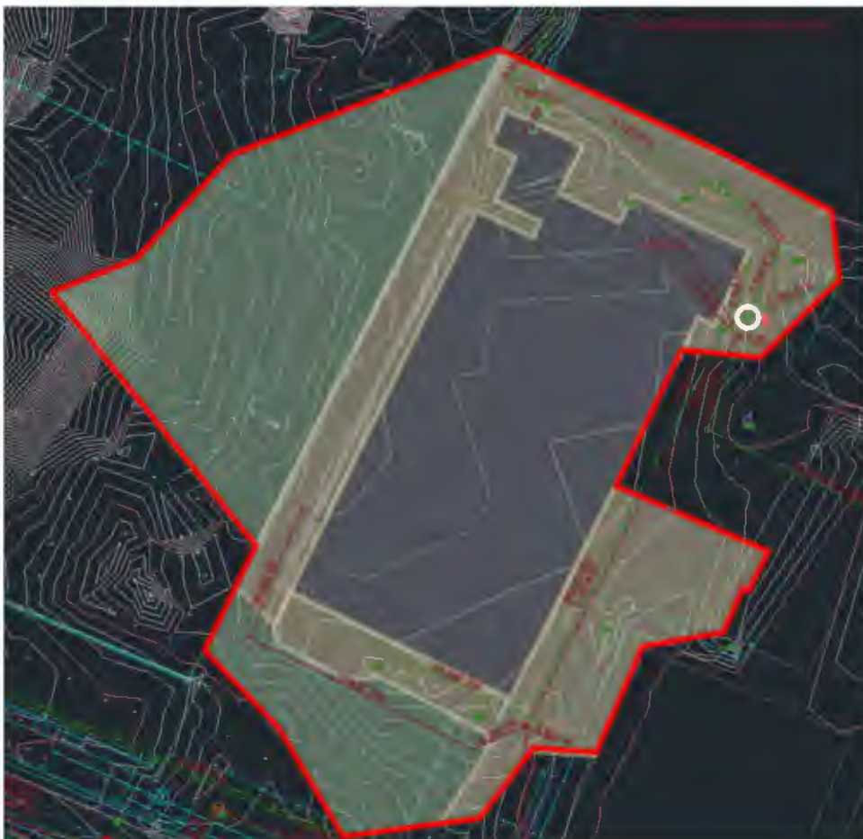
Figur 5. Fördelning av ytorna innan ombyggnation. Bruna ytor är grusytor, mörkgråa ytor är takytor och gröna ytor är grönytor.
